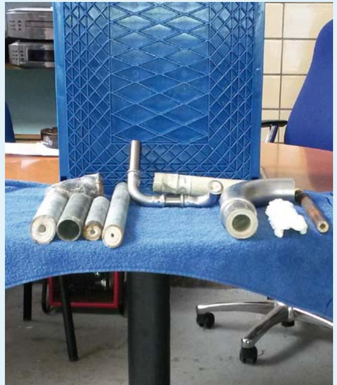
Verschiedene Beispiele für verkalkte Rohrstücke
